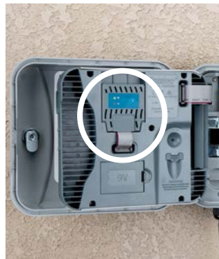
PC-WiFi WLAN-Modul für PRO-C Steuergeräte, Verwaltung in Centralus-Software Seite 124
