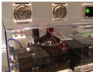
Cada valve Hunter se somete a pruebas de agua para verificar la fiabilidad, la durabilidad y el rendimiento.
