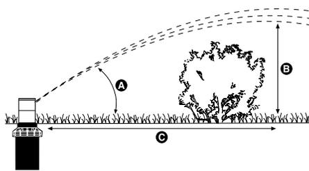
Estas tablas de la trayectoria de la nozzle del rotor han sido diseñadas para ayudarle a determinar la distancia a la que puede colocarse un sprinkler de un objeto, como una valla o un seto, sin obstruir la trayectoria del chorro. La información que se indica está calculada a una presión de funcionamiento óptima.
