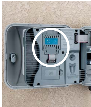
PC-WIFI Accessoire Wi-Fi pour programmeur Pro-C, géré par le logiciel Centralus Page 124
