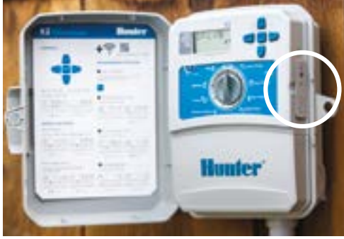
WAND Modülü takılı X2 Kontrol Ünitesi
